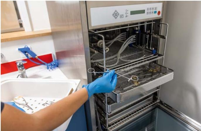
**Tipp** | Bei der Beladung des Autoklavs sind die Herstellerangaben strikt zu befolgen, dies betrifft vor allem das Beladungsvolumen/-gewicht und die Art der zu sterilisierenden Materialien. Schwere Container sollten immer unten und leichte Container oder Folienverpackungen in den oberen Bereich des Autoklavs gestellt werden. Nur so ist eine sichere Sterilisation aller Instrumente gewährleistet.
